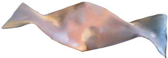
Не полное сжигание топлива и перегрев можно определить как с топочной камеры, трубных плит и дымогарных труб, так и по состоянию турбулизаторов. Красный и бордовый цвет турбулизаторов означает неравномерное распределение тепла и перегрев. Перегрев турбулизатора особенно ярко выражен на первых поворотах витой ленты и на прямой ручке с фиксирующим изгибом. По ходу потока газов через дымогарную трубу, снижается температура и витая лента после нескольких поворотов уже имеет изначальный цвет.
