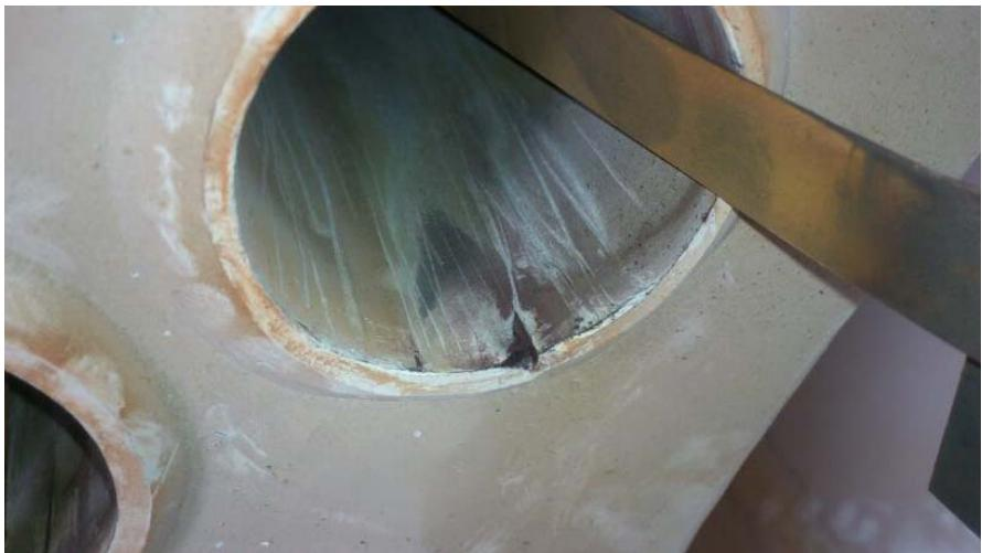
Не равномерная тяга дымовой трубы, неправильный подбор горелочного оборудования или неправильные потоки дымовых газов через дымогарные трубы могут привести к постоянному движению турбулизаторов в дымогарных трубах как в горизонтальном направлении так и с завихрением и вертикальным смещением, что оставляет отметки на поверхностях дымогарных труб. Данные места особенно
