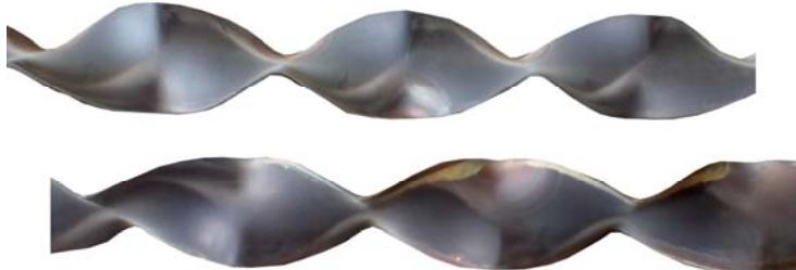
Турбулизаторы с легким оттенком и чистая топочная камера указывают на точные настройки режимов горения с полным сжиганием, правильное обслуживание и эксплуатацию.
