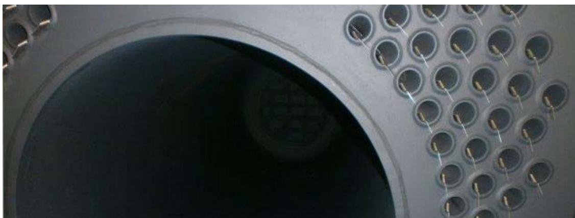
Турбулизаторы устанавливаются только со стороны передней двери
